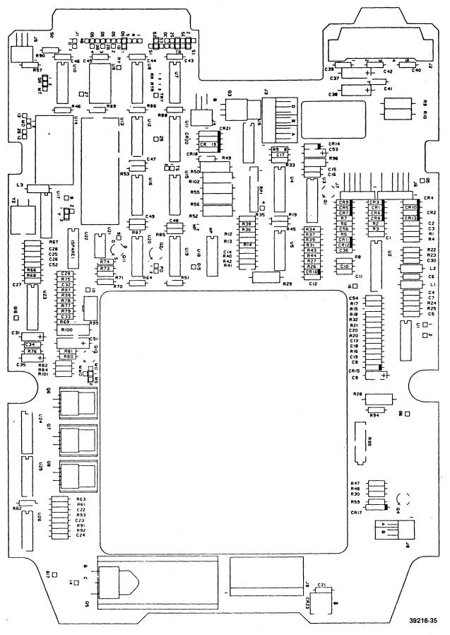
FIGURE 7-2. PCB COMPONENT LOCATIONS (P/N 25249)
